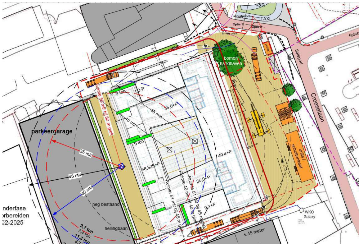
Afb. Bouwveiligheidszone binnen de bouwhekken
